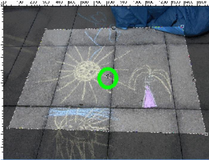
Nach einem abschließenden Doppelklick auf den Auswahlbereich erhält man ein fertig entzerrtes Orthobild von dem ausgewählten Bereich, den man anschließend im Familienalbum ablegen kann.
