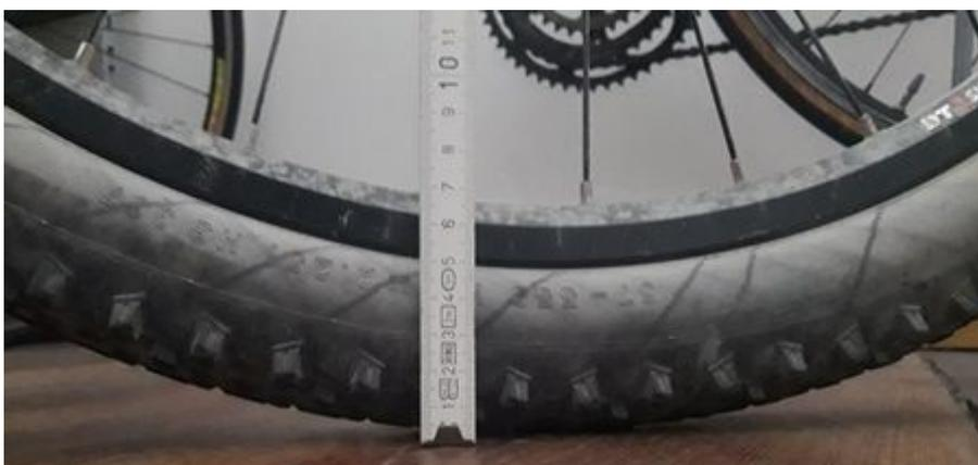
Bei einem 26"-MTB-Reifen (57-559 (26 x 2.25)) bewegt sich die Flankenhöhe  $a$  im Bereich 5 cm. Bei Fahrradunfällen, bei denen man versucht, aus den Spuren an den Fahrzeugen eine Höhenzuordnung vorzunehmen und hieraus auf einen gebremsten oder ungebremsten Zustand des Kfz schließt, sollte man den Umstand berücksichtigen, dass der Reifen vor der Kollision gefüllt war und danach oft entlüftet.
