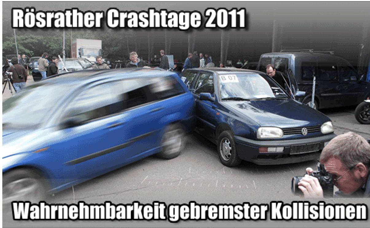
Die Rösrather Crashtage 2011 befassten sich mit dem Thema "Wahrnehmbarkeit gebremster Kollisionen". Dabei wurden sowohl ungebremsste als auch gebremste Kollisionen durchgeführt. Die Unterschiede wurden messtechnisch ausgewertet und aufbereitet.
