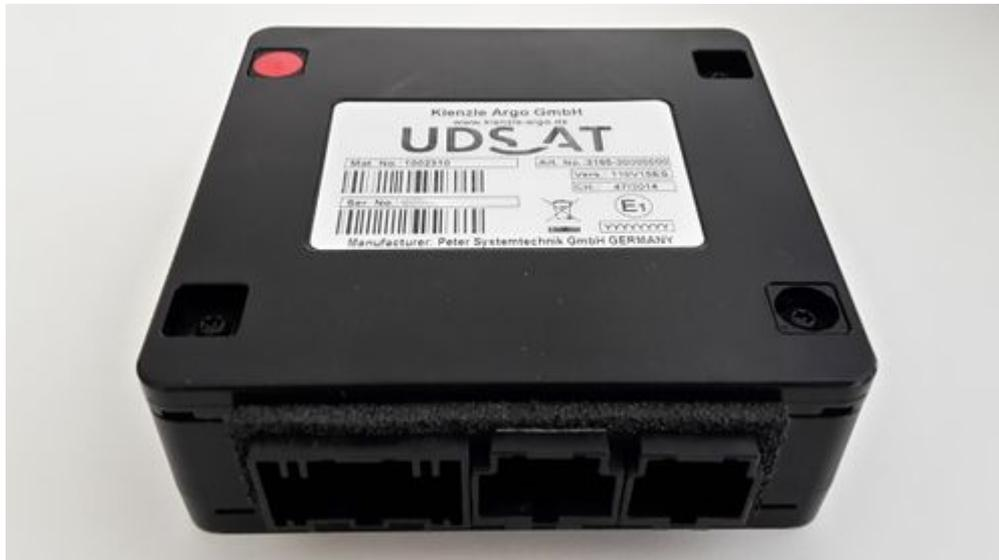
UDS-AT mit 3 Schnittstellen; im Bild links 16-polig (Fahrzeuganschluss), mittig 10-polig (GPS, UDS-Taster), rechts 8-polig (USB 2.0)
