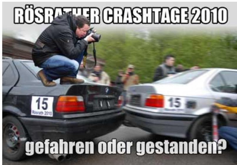
Die [Rösrather Crashtage](#) 2010 befassten sich mit dem Thema: Gefahren oder gestanden? Dazu wurden Versuche durchgeführt, bei dem das gestoßene Fahrzeug jeweils bei der ersten Kollision bewegt wurde und bei der zweiten Kollision stand.
