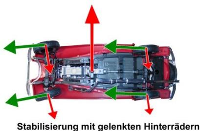
und um dies zu verhindern kann man den Driftwinkel eben komplett unterdrücken. Eine vollständige Vermeidung des Driftwinkels ohne Verluste bei der Kurvengrenzgeschwindigkeit ist aber nur mit gelenkten Hinterrädern - zumindest theoretisch - möglich. Für die
