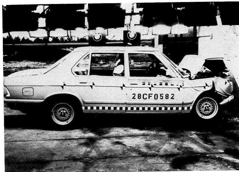
Frontalaufprall mit voller Überdeckung Fahrzeugmasse 1450 kg Kollisionsgeschwindigkeit 49,9 km/h Max. bleibende Deformation 567 mm EES = 49 km/h
