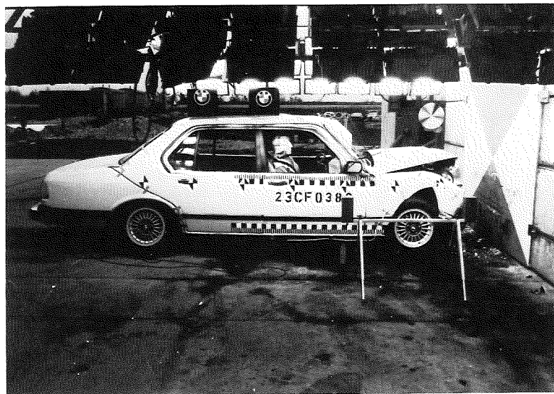
Frontalaufprall mit voller Überdeckung Fahrzeugmasse 1805 kg Kollisionsgeschwindigkeit 48,6 km/h Max. bleibende Deformation 455 mm EES = 48 km/h
