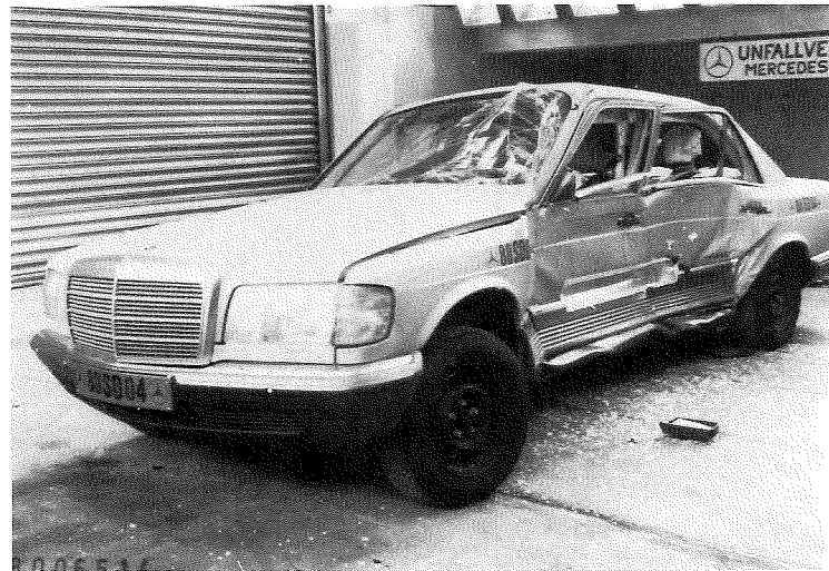
Seitenaufprall mit Stoßwagen Masse des Stoßwagens 1590 kg Fahrzeugmasse 1833 kg Kollisionsgeschwindigkeit 45,8 km/h Max. bleibende Deformation 320 mm EES = 31 km/h
