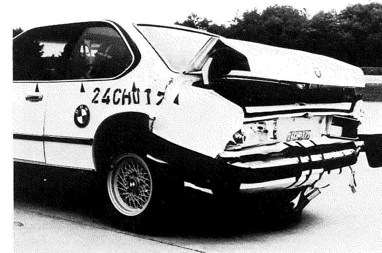
Heckaufprall mit Barriere Masse des Stoßwagens 1814 kg Fahrzeugmasse 1810 kg Kollisionsgeschwindigkeit 50,2 km/h Max. bleibende Deformation 347 mm EES = 35 km/h
